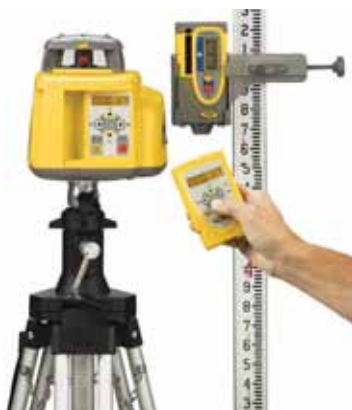
Нивелир – используется для планировки форм рельефа на местности
